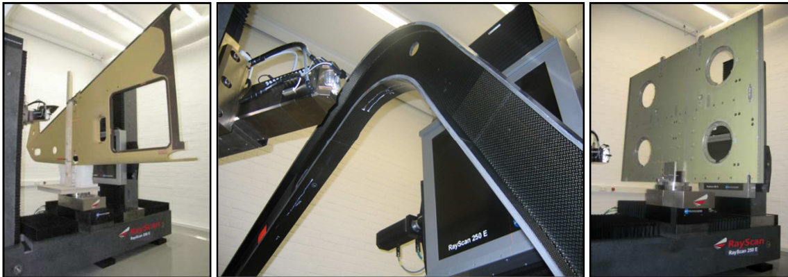
Abbildung 4 Transversal-CT: oben: Schematische Ansicht, unten: CT-System RayScan 250 E bestückt mit verschiedenen Objekten aus Faserverbundmaterialien, links: Seitenverkleidung eines Helikopters, Mitte: Rahmen, rechts: Bodengruppe.
