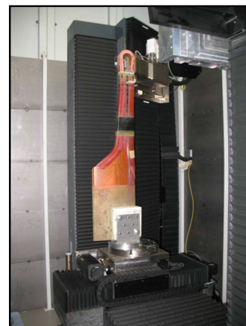
Abbildung 3 Helix-CT: links: Schematische Ansicht, rechts: CT-System RayScan 250 E.
